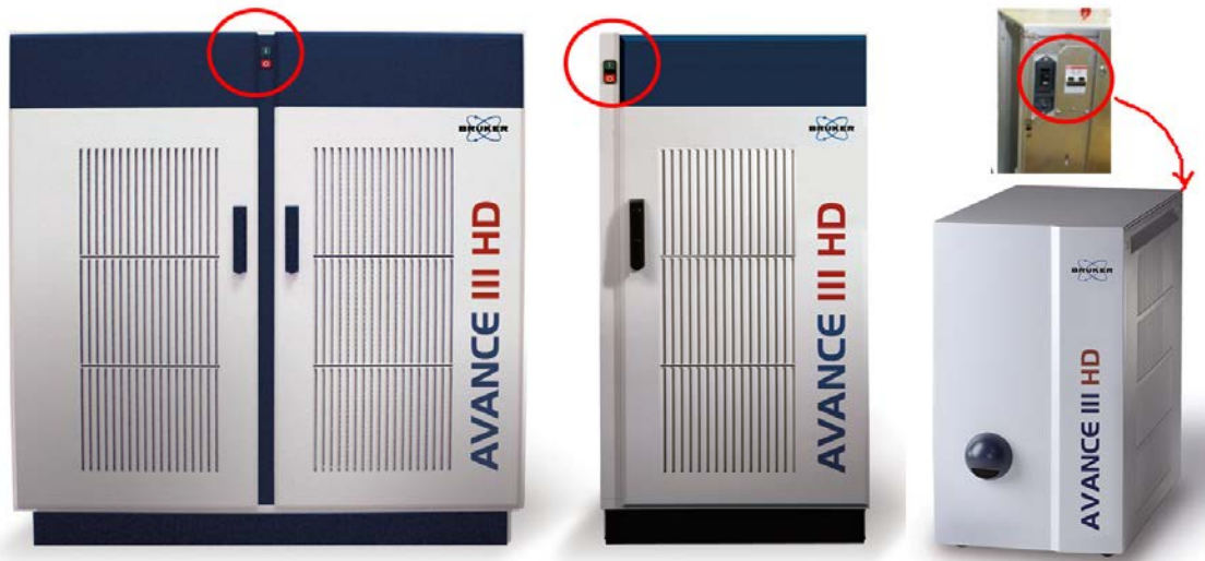
Figura 3.3: Posizione dell'interruttore di arresto di emergenza sulla serie AVANCE III HD
