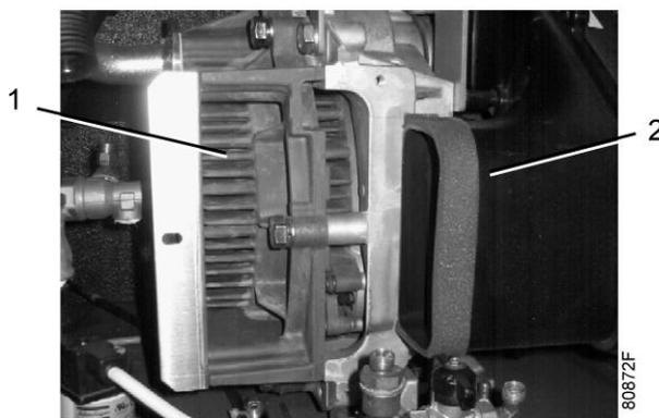
5. Reassemble the fan duct:
